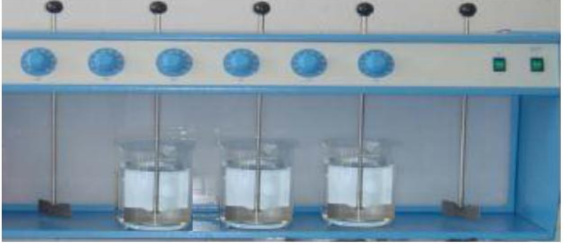
řekil 3.18. Dezenfektan optimizasyon alıřmalarında kullanılan jar test dzeneęi
