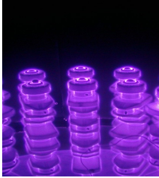
Şekil 2.22. Dizel araçlarda kullanılan krank millerin PN işlemi sırasındaki görüntüsü (Topçu 2010)
