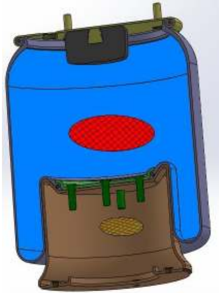
Resim3. 22 Hava Süspansiyon Körük Yapısı
