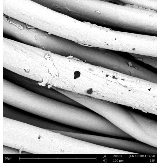
Şekil 4.50. PFRWR1F kumaşının ön yüzünün SEM görüntüsü
