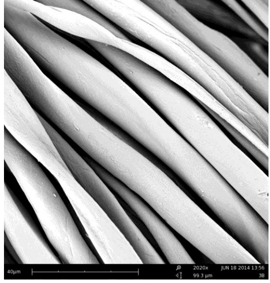
Şekil 4.42. CPF1 kumaşının arka yüzünün SEM görüntüsü
