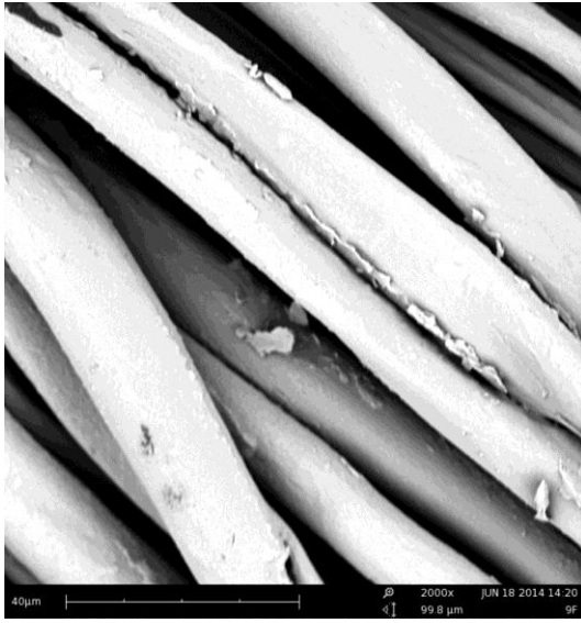
Şekil 4.47. PWR kumaşının ön yüzünün SEM görüntüsü
