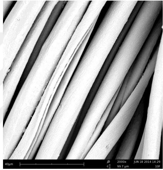
Şekil 4.48. WR1F kumaşının ön yüzünün SEM görüntüsü
