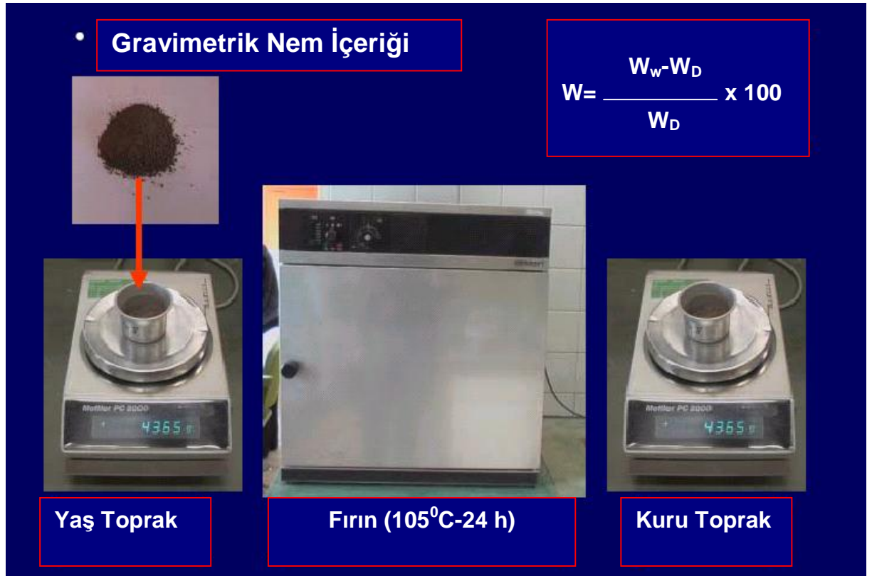
Şekil 3.3. Parsellerden Alınan Toprak Örneklerinin Nem İçeriğinin Belirlenmesi
