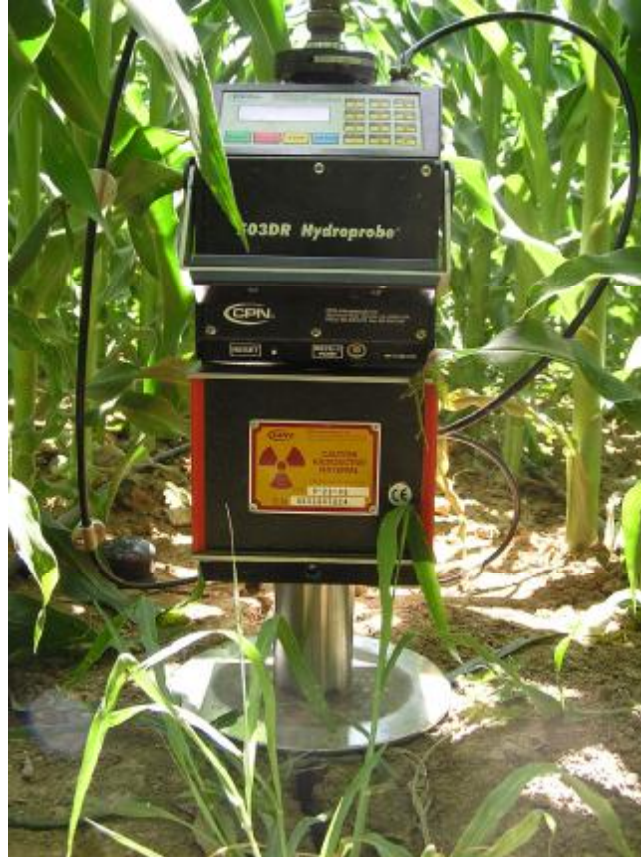
Şekil 3.6. Parsellerde Nötronmetre Ölçümü
