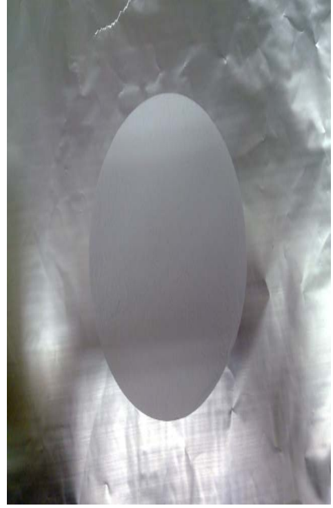
Şekil 3.7. YHHÖ'de kullanılan Puf Kartuş ve cam elyaf filtre
