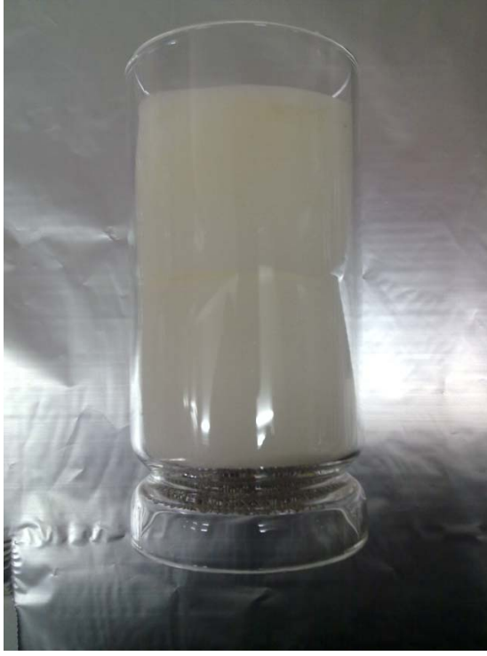
Şekil 3.7. YHHÖ'de kullanılan Puf Kartuş ve cam elyaf filtre
