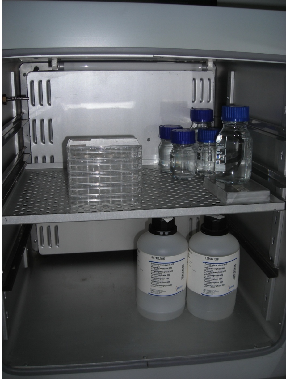
Şekil 3.18. Su kaybına toleranslılık denemesi için hazırlanan ve oda sıcaklığına ayarlı inkübatöre konan kaplar
