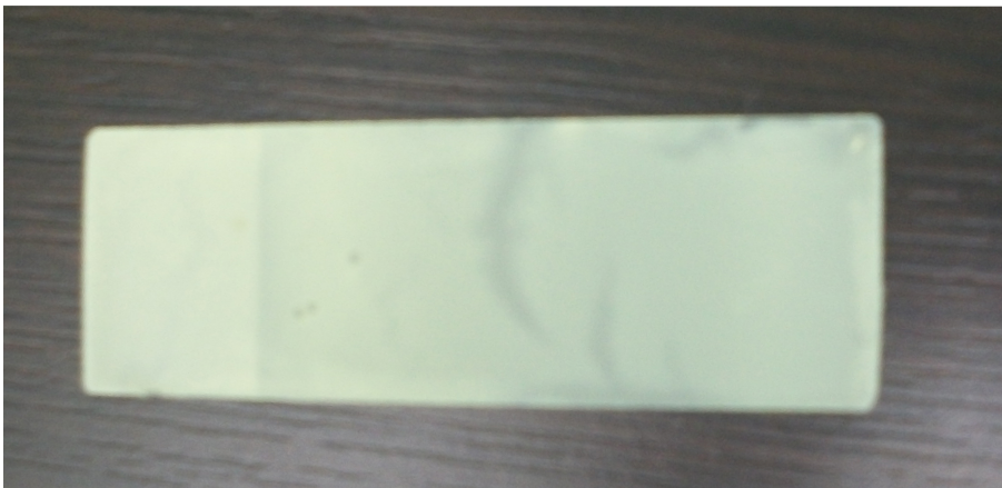
Şekil 3.4. Temas açısı ölçümü için hazırlanan film
