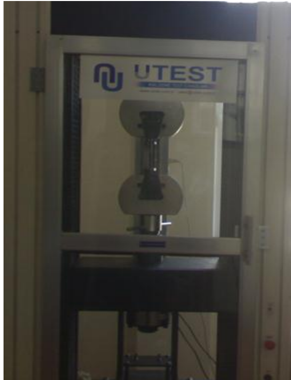
Resim 2.1 –Deneylerde Kullandığımız Çekme Cihazı (Uludağ Üniversitesi Makine Mühendisliği laboratuarı )
