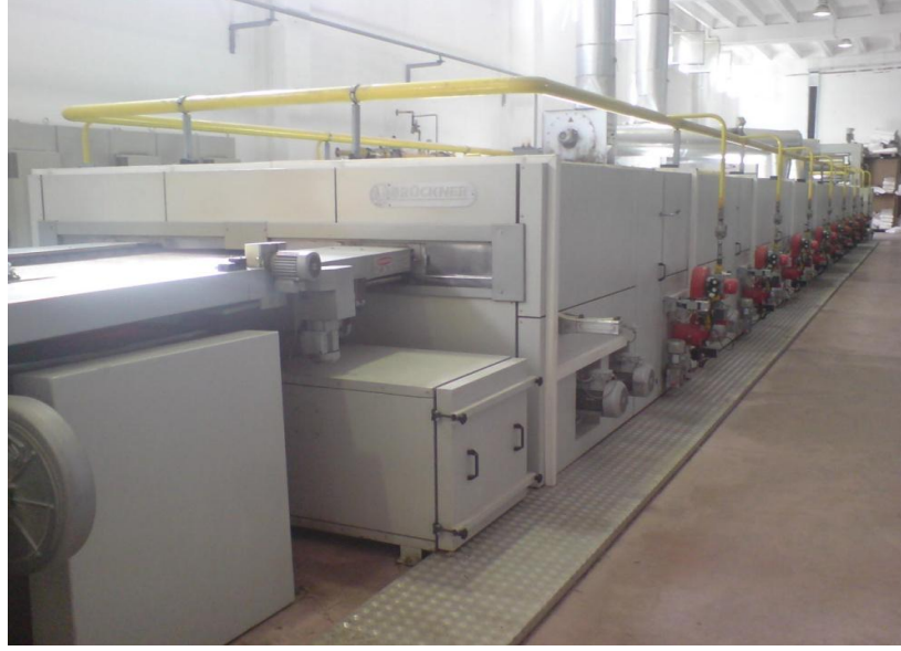
Şekil 3.14. Brückner ram makinesi
