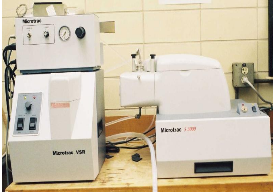
Şekil 3.2. Microtrac S3000 partikül boyut analiz cihazı
