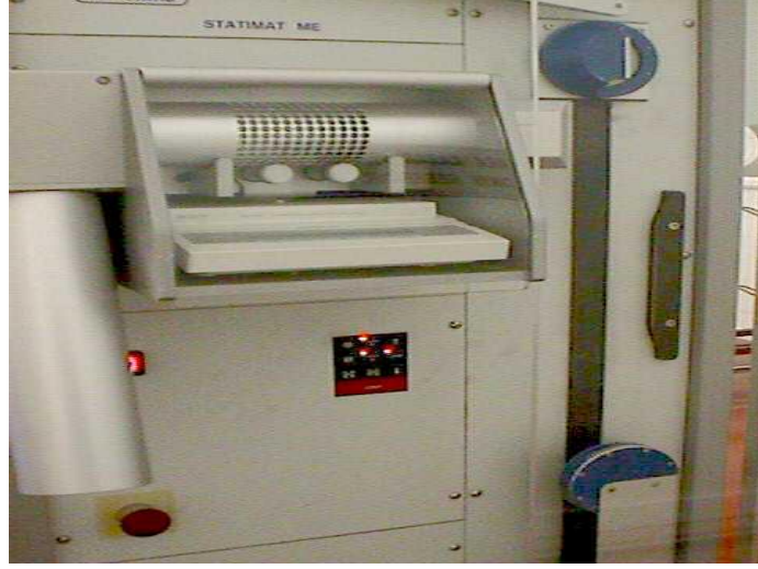
Şekil 3.10. Statimat Kopma-uzama tayini cihazı
