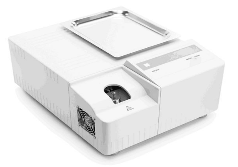
Şekil 3.5. Mettler Toledo Stare System DSC 823e cihazı
