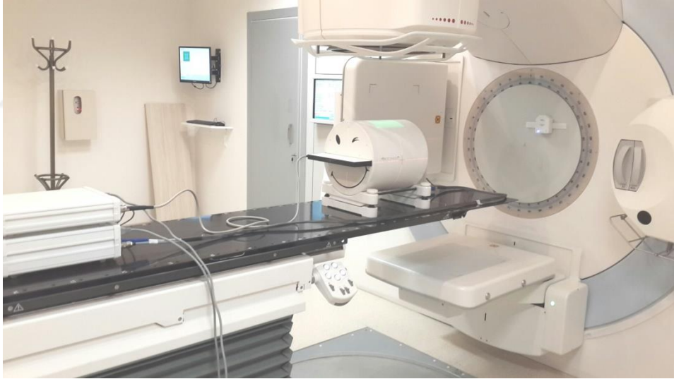
Şekil-25 Üç boyutlu ölçümler için Octavius silindirik katı su fantomu ile oluşturulan ölçüm düzeneği
