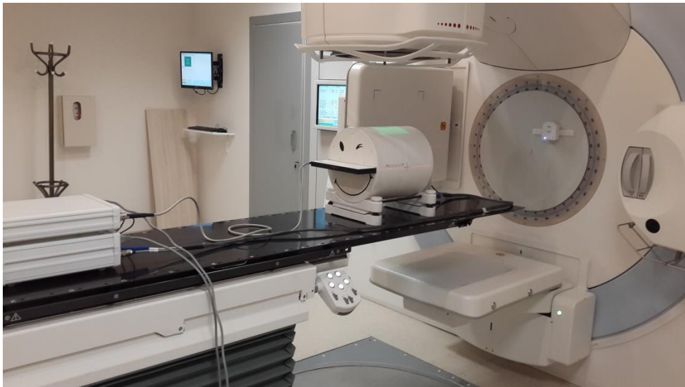
Şekil-28 VMAT için Octavius silindirik katı su fantomu ile oluşturulan ölçüm düzeneği
