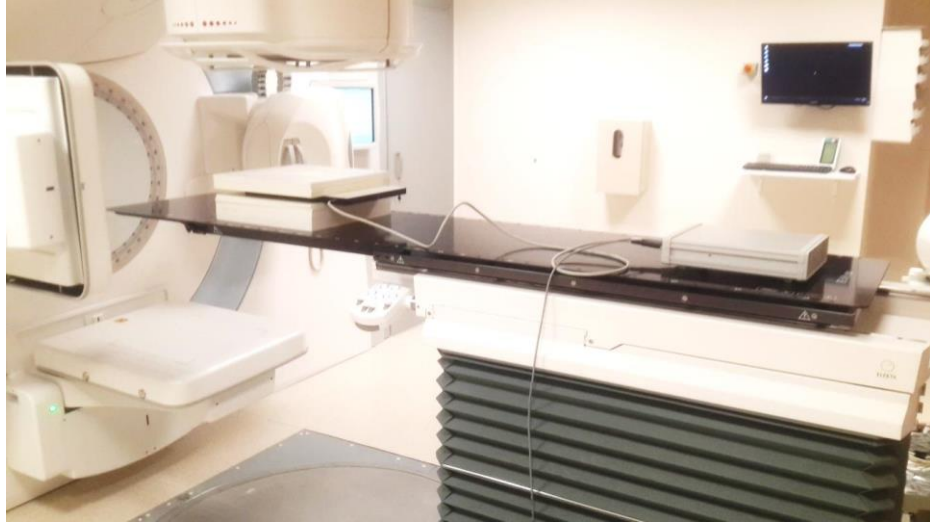
Şekil-26 İki boyutlu ölçümler için RW-3 katı su fantomu ile oluşturulan ölçüm düzeneği
