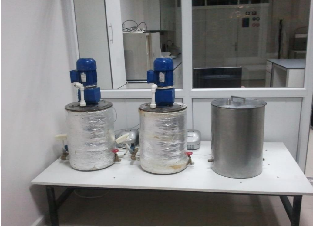
Şekil 3.2 Deneyde kullanılan kesikli aerobik kompost reaktörlerin görünümü
