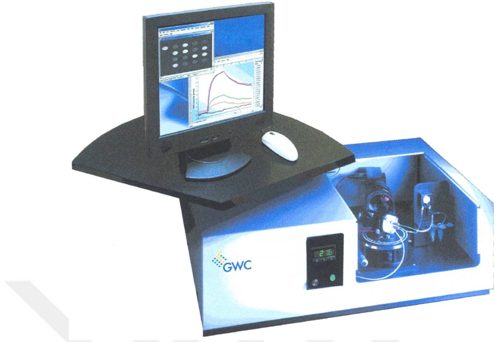
Şekil 3.2.6.1.1. SPRImager II (GWC Technologies, Madison, ABD) yüzey plazmon rezonans sistemi
