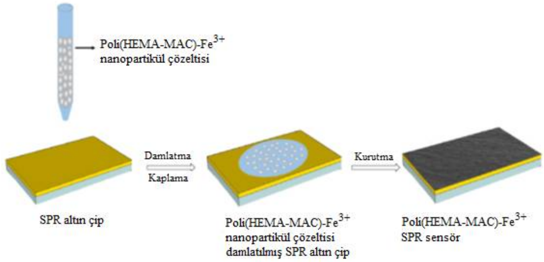
Şekil 3.2.5.2.1. Poli(HEMA-MAC)-Fe 3+ nanopartiküllerin SPR sensör yüzeyine kaplanması
