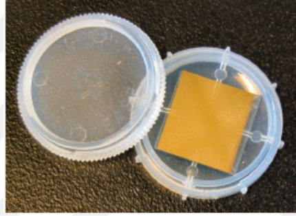
Şekil 3.2.5.1.1. GWC SPRimager II sisteminde kullanılan SPRchip TM altın çip (Osman 2011)
