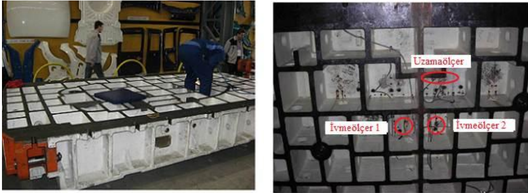
Şekil 4.22. İvmeölçerlerin kalıp üzerine montaj işlemi ve konumları
