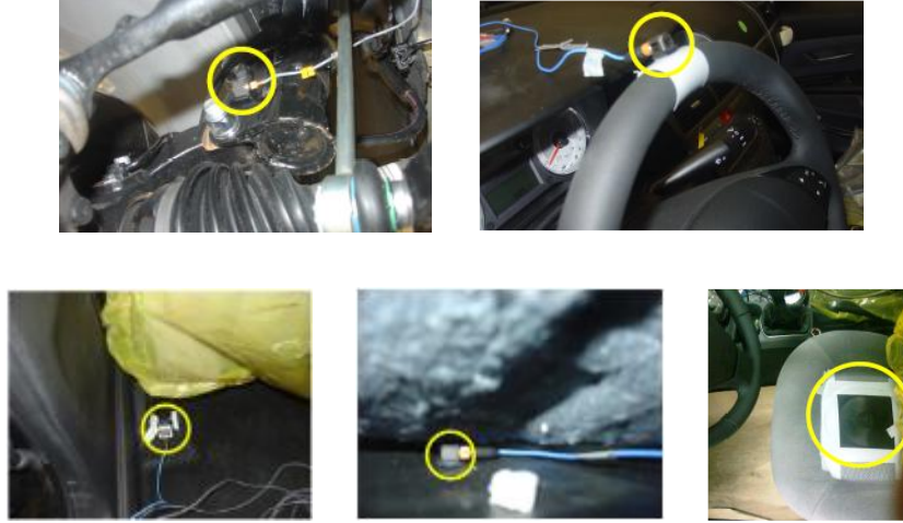
Şekil 4.4. Yol testlerinde kullanılan araç üzerine yerleştirilen ivmeölçerler (akson, direksiyon, koltuk, ayak bölgesi ve döşeme altı)
