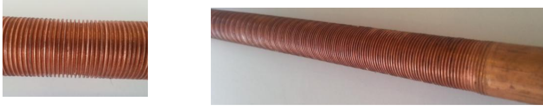
Şekil 4.14. Eşanjör boru detayları
