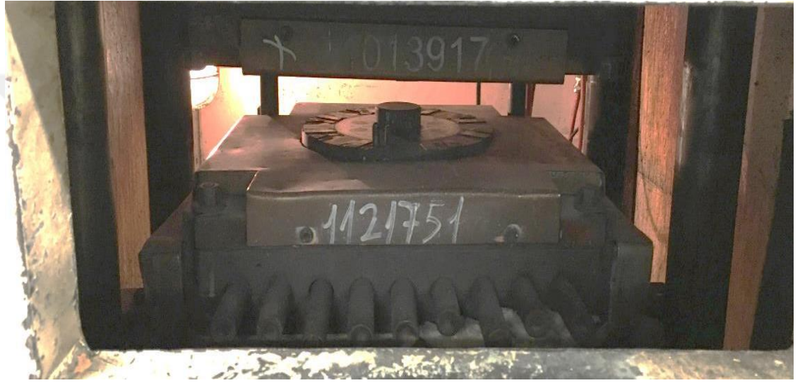
Şekil 4.5. Metalik disk yayı sıcak şekillendirme
