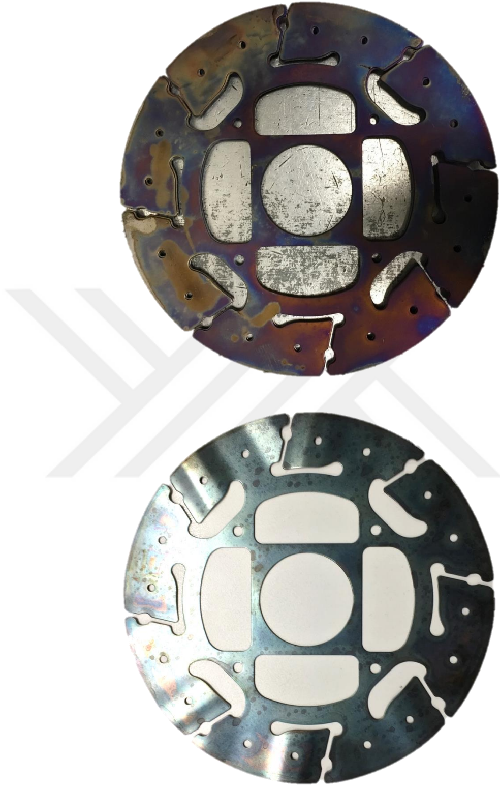
Şekil 4.37. Isıl işlem sonrası ve sıcak formlanmış prototip metalik disk yayı
