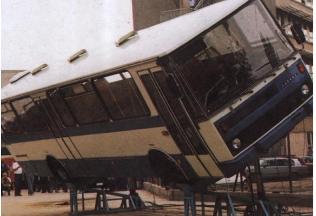
Şekil 2.7 Tüm araç devrilme testi (Vincze, 1998)
