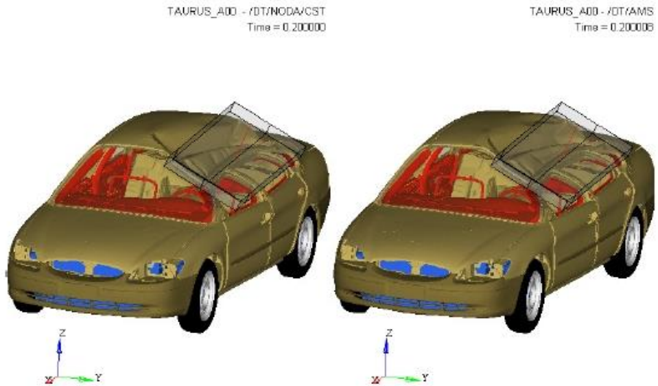
Şekil 3.20 Geleneksel kütle ekleme ve AMS metodu kullanılan simülasyon sonucu (Bobineau ve ark., 2013)
