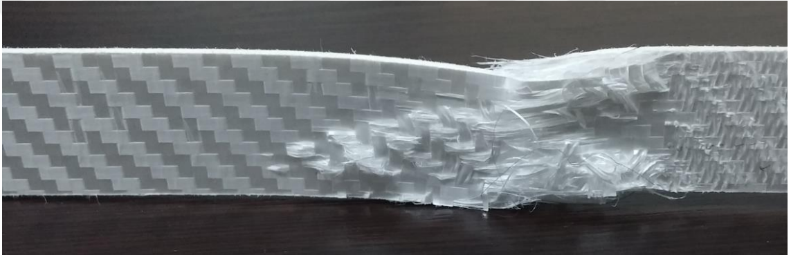
Şekil 4.3. Kendinden takviyeli 12 katmanlı Pp kompozit malzemelerin standart çekme deney sonuçları
