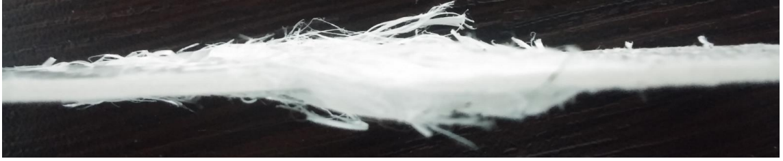
Şekil 4.2. Kendinden takviyeli 12 katmanlı Pp kompozit malzemelerin standart çekme deney sonuçları
