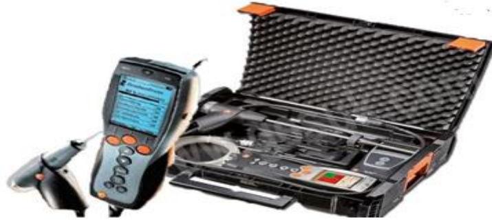
Şekil 3.8. Baca gazı analizinde kullanılacak olan cihaz
