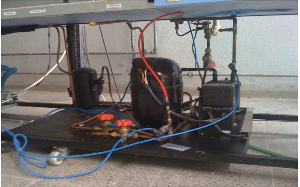
Şekil 3.17. Kurutma ünitesinde kullanılan ısı pompası devresi
