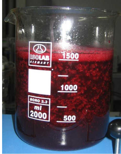
Şekil 4.1. Laboratuvar ölçekte yapılan asit kraking işleminde oluşan yağlar
