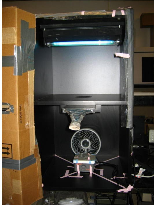
Şekil 3.7. Yurtdışı çalışmalarında kullanılan UV düzeneği
