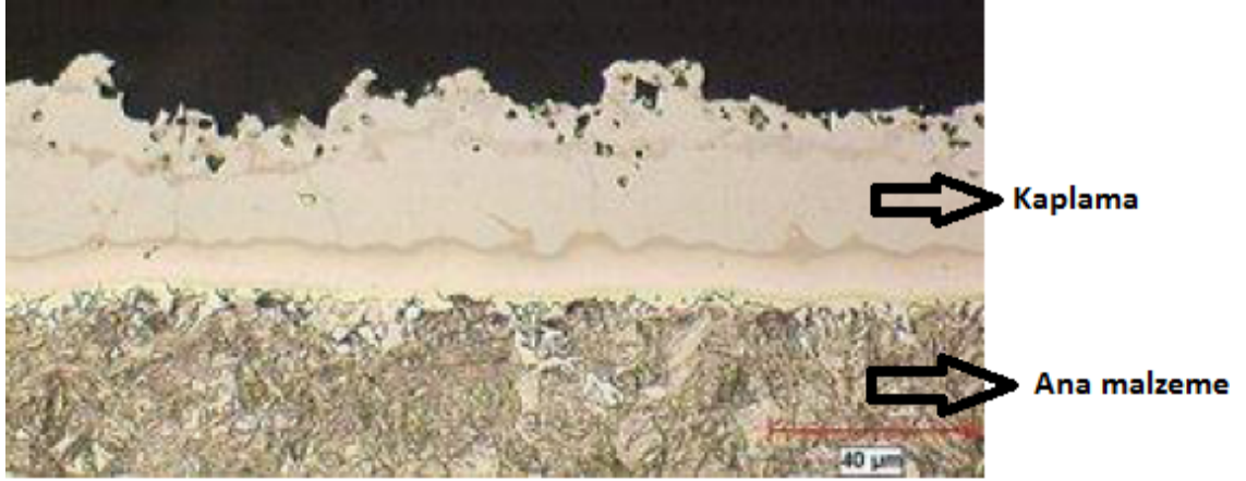
Şekil 2.21. Usibor 1500 ana malzeme ve kaplamanın optik mikroskop görüntüleri ( http://www.arcelormittal.com , 2012)
