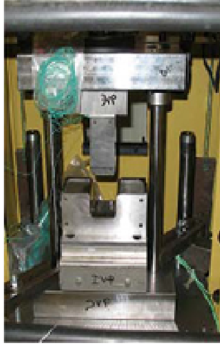
Şekil 2. 30. Sıcak şekillendirme işleminin örnek bir deneysel düzeneği (Abdulhay ve ark. 2009)
