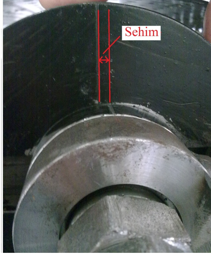
Şekil 3.21. Yorulma deneyi gerçekleştirilen cihazda sehim ayarı
