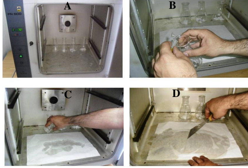
Şekil 3.3. Denemede kullanılan kimyasalların uygulamalara hazırlanması A) Parafinlerin 70 °C’de etüvde eritilmesi B) Uçucu yağların eritilmiş parafinler içerisine karıştırılması C) Parafin+uçucu yağ (timol veya ögenol) karışımının 25x35 boyutlarındaki kurutma kağıtlarının yüzeyine dökülmesi D) Parafin+uçucu yağ (timol veya ögenol) karışımının kurutma kağıdının yüzeyine homojen olarak dağıtılması
