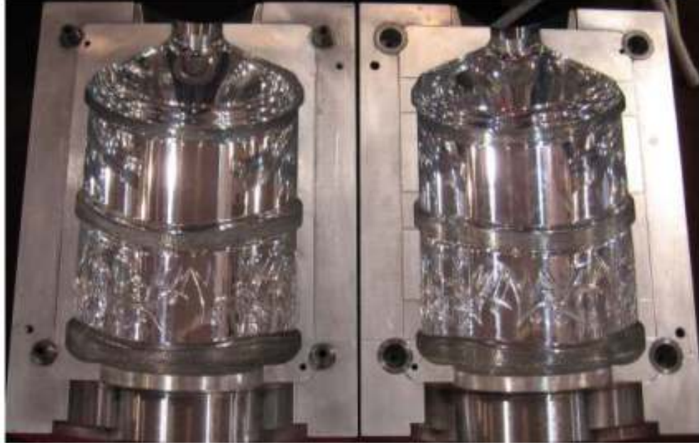
Şekil 2.7. Plastik Kalıp Çeliğinden Üretilmiş Plastik Şişirme Kalıbı
