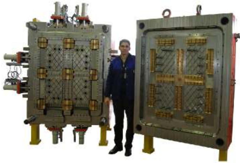
Şekil 3.1. Plastik Enjeksiyon Kalıbı (Plastik Palet)
