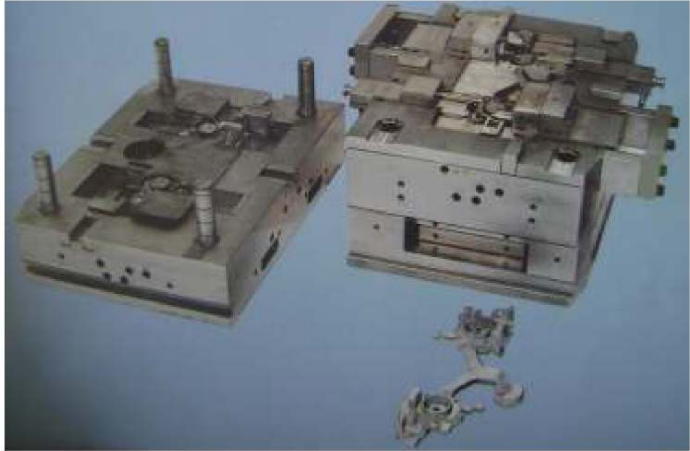
Şekil 2.5. Sıcak İş Çeliğinden Yapılan Plastik Enjeksiyon Kalıbı
