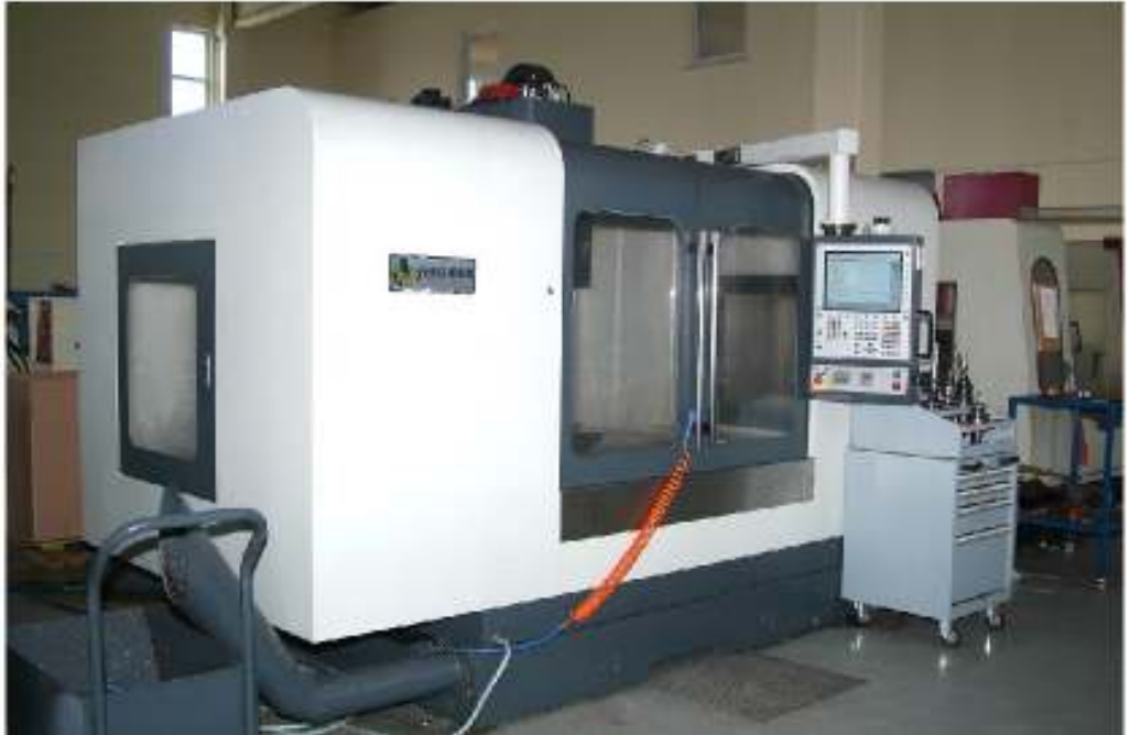
Şekil 3.5. Kalıp İmalatında Kullanılan CNC İşleme Merkezi
