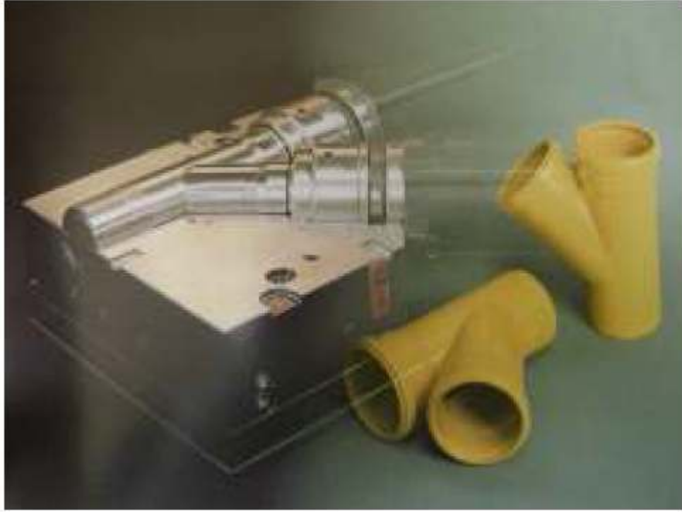
Şekil 2.6. Plastik Kalıp Çeliğinden Üretilmiş Kalıp
