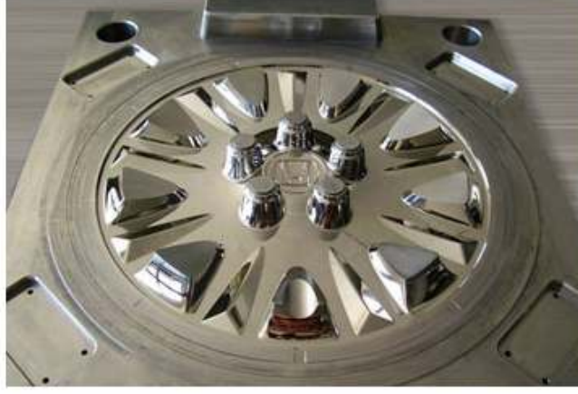
Şekil 3.6. Parlatma İşlemine Tabi Tutulmuş Kalıp
