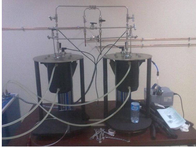
Şekil 3.19. Gazın depolandığı ve adsorpsiyonun gerçekleştiği tanklar
