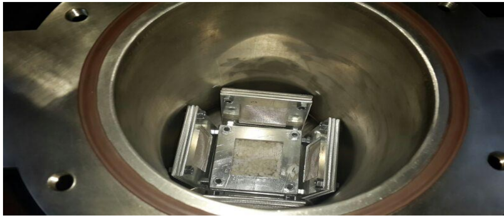
Şekil 3.18. Adsorbentın adsorpsiyon ünitesi içine yerleştirilmesi
