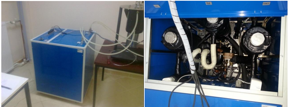
Şekil 3.20. Sirkülasyon suyunun sıcaklığını ayarlayan ve plc sisteminin bulunduğu adsorpsiyon ünitesi
