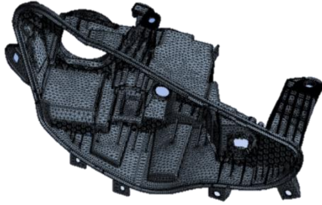
Şekil 4.9. Far gövdesinin sonlu elemanlar ağı
