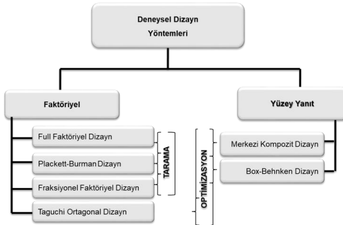
Şekil 2.4. Pestisit tayinlerinde metot parametrelerinin optimizasyonu için kullanılan kemometrik metotlar (Narendaran ve ark. 2019)
