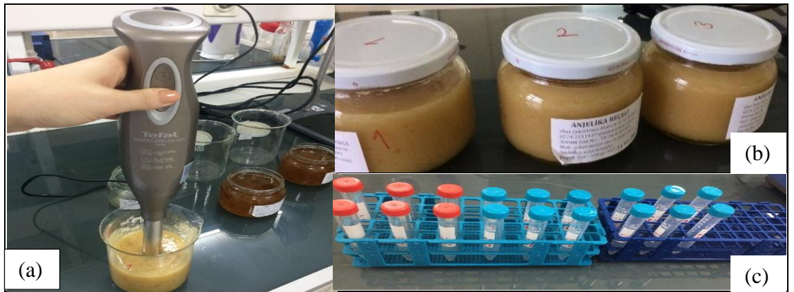
Şekil 3.5. Numune hazırlama aşamaları (a) homojenizasyon, (b) homojen hale getirilen numuneler, (c) polipropilen kaplara alınan numuneler
