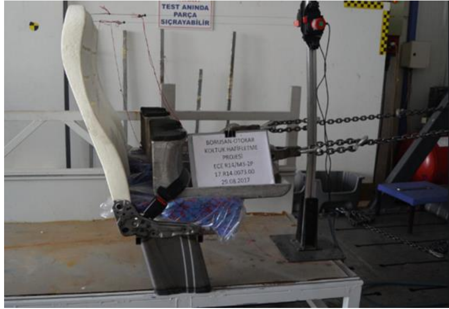
Şekil 2.6 ECE-R14 Çekme testi örneği
