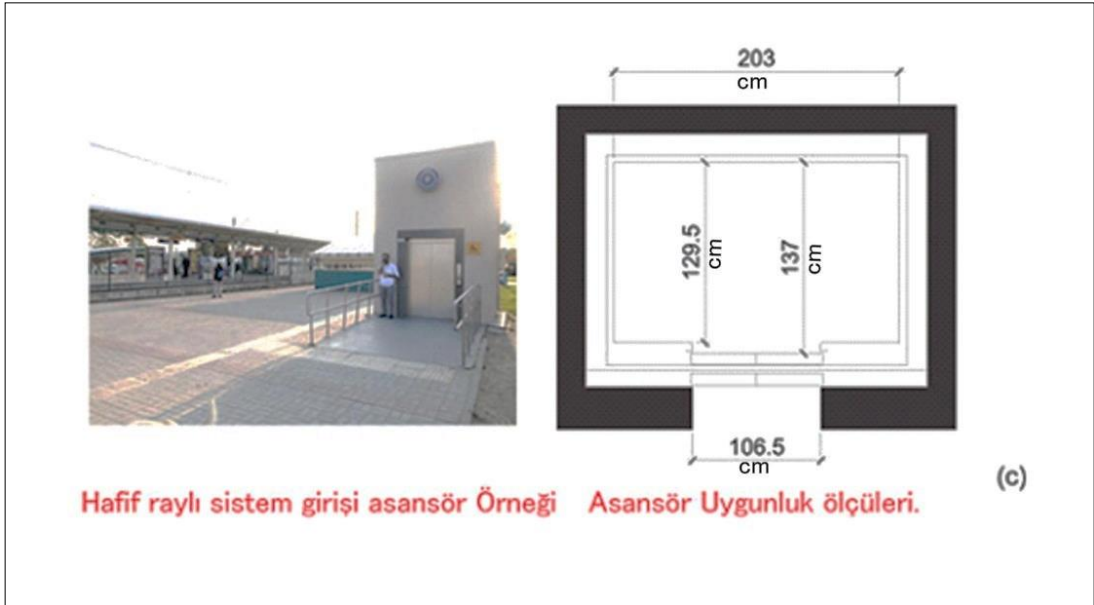
Şekil 4.16. Hafif raylı sistem asansör-yol ilişkisi ve standart ölçüleri (Kasım HANİK, 2019-Orijinal)
