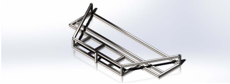
řekil 4.9. 60x60x3 mm çatı karkas izim grseli
