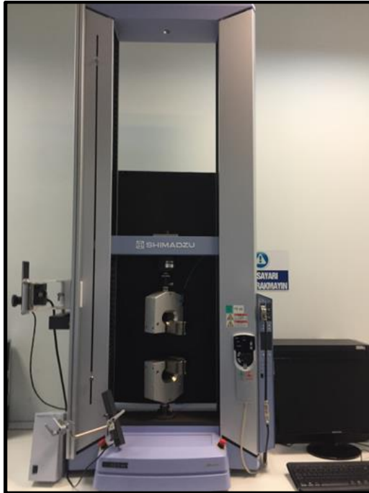
Şekil 3.5. Mukavemet ölçüm test cihazı (Shimadzu AG-XHS)
