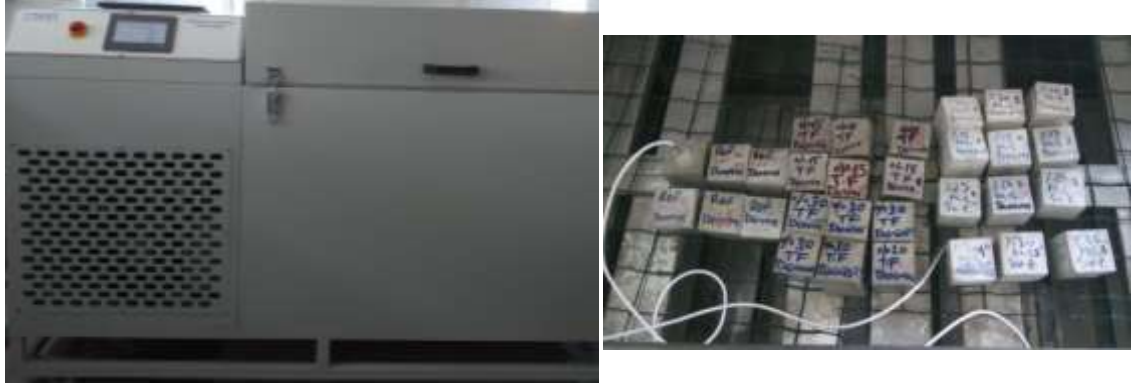
Şekil 3.28. Donma çözülme deneyinin yapıldığı cihaz ve örnekler
