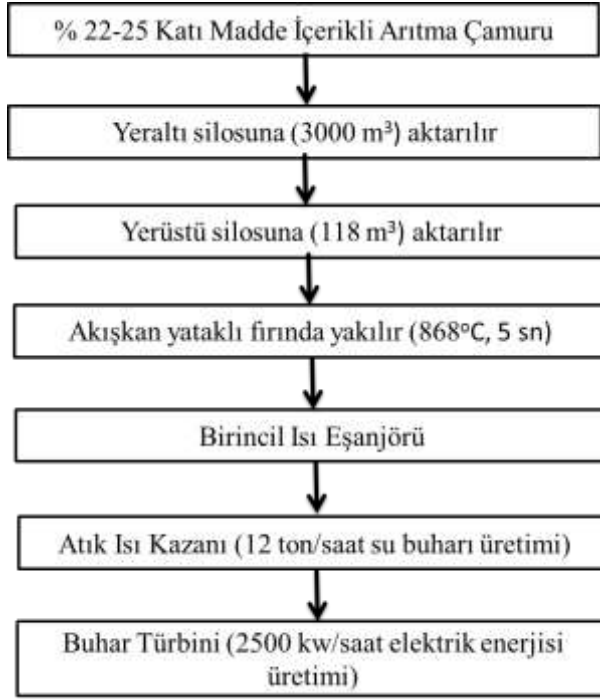
Şekil 3.5. Çamur yakma tesisi – enerji üretimi akım şeması
