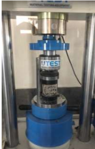
Şekil 3.26. Basınç dayanımı düzeylerinin belirlendiği cihaz
