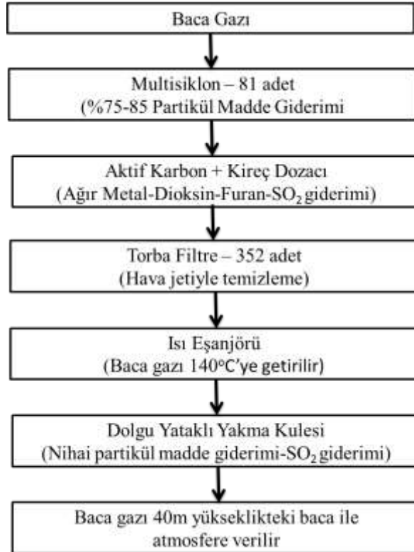
Şekil 3.6. Çamur yakma tesisi – emisyon kontrolü akım şeması
