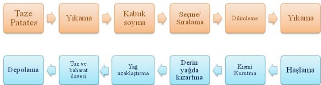
Şekil 2.4. Derin yağda kızartma yöntemiyle üretilen cipslerin üretim akış diyagramı (Pedreschi ve ark. 2007, Baltacıođlu ve Esin 2013)
