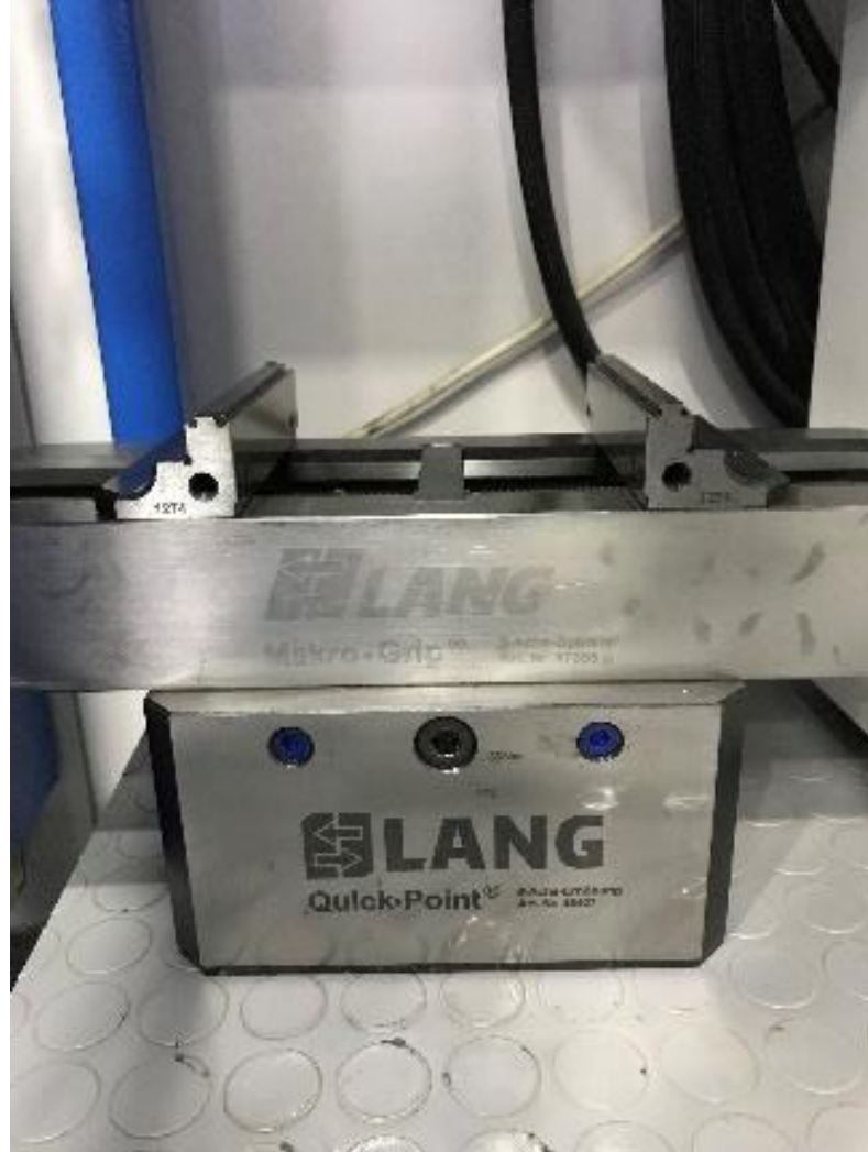
Şekil 3.1. Parçaların bağlanması için kullanılan Lang marka mengene.
