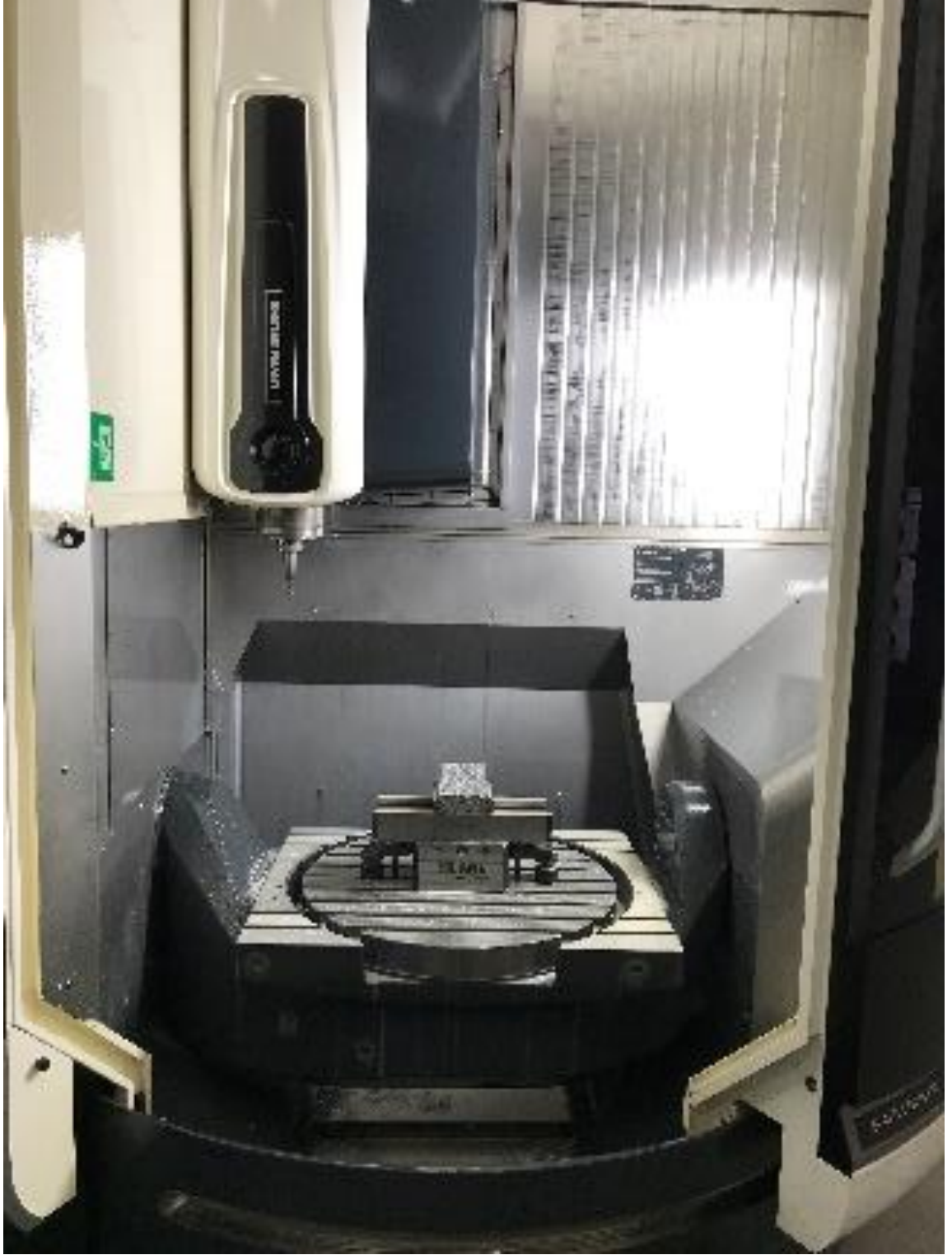
Şekil 3.2. Kesme işlemleri için kullanılan 5 eksenli işleme merkezi (DMG DMU-75 MonoBLOCK) ve bağlanmış parçaya ait görsel.
