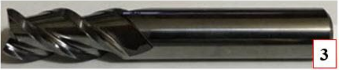
Şekil 3.5. YG-1 markalı 3 ağızlı Ø12 karbür kesici takım görseli.
