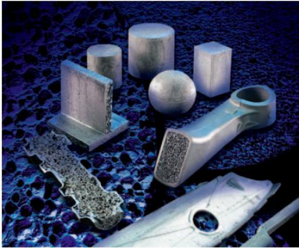
Şekil 1.2. Kalıplama metoduyla dökülmüş alüminyum köpük parçaları (Alulight 2006).
