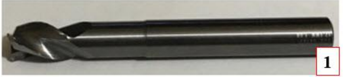
Şekil 3.3. Kyocera markalı 3 ağızlı Ø12 karbür kesici takım görseli.
