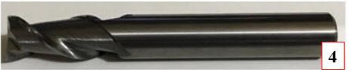
Şekil 3.6. YG-1 markalı 2 ağızlı Ø12 karbür kesici takım görseli.
