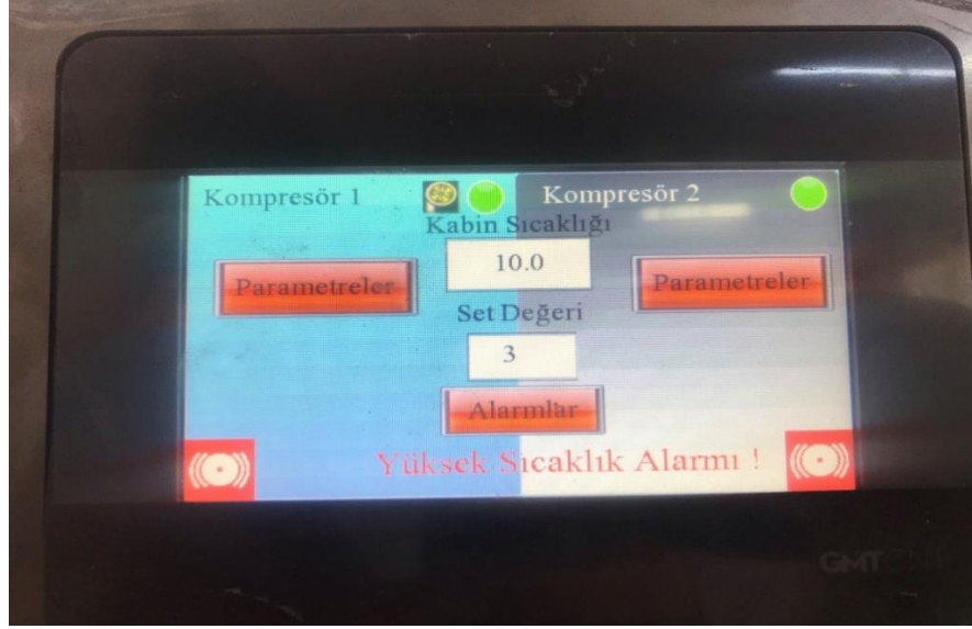
Şekil 4.4. 7 °C 'nin üzerindeki durumlarda HMI görüntüsü
