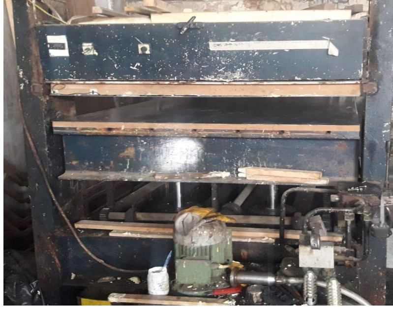
Şekil 3.5. Dolap yan panellerinin içine poliüretan basılan kalıp
