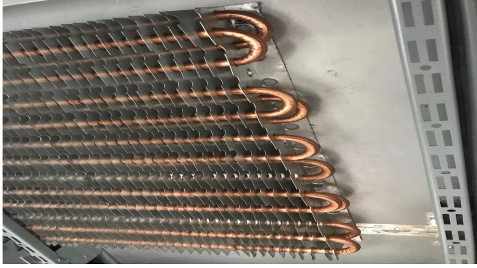
Şekil 4.2. Üretimi yapılan evaporatör
