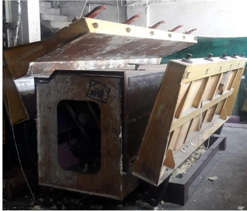
Şekil 3.6. Dolap karkasına poliüretan basılan kalıp
