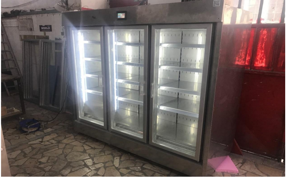
Şekil 4.9. Aşı ve ilaç dolabının bitmiş hali
