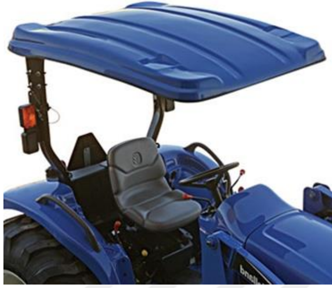
Şekil 3.4. Tarla Traktörlerinde Kullanılan Arka YKEY'e Entegre Kanopi
