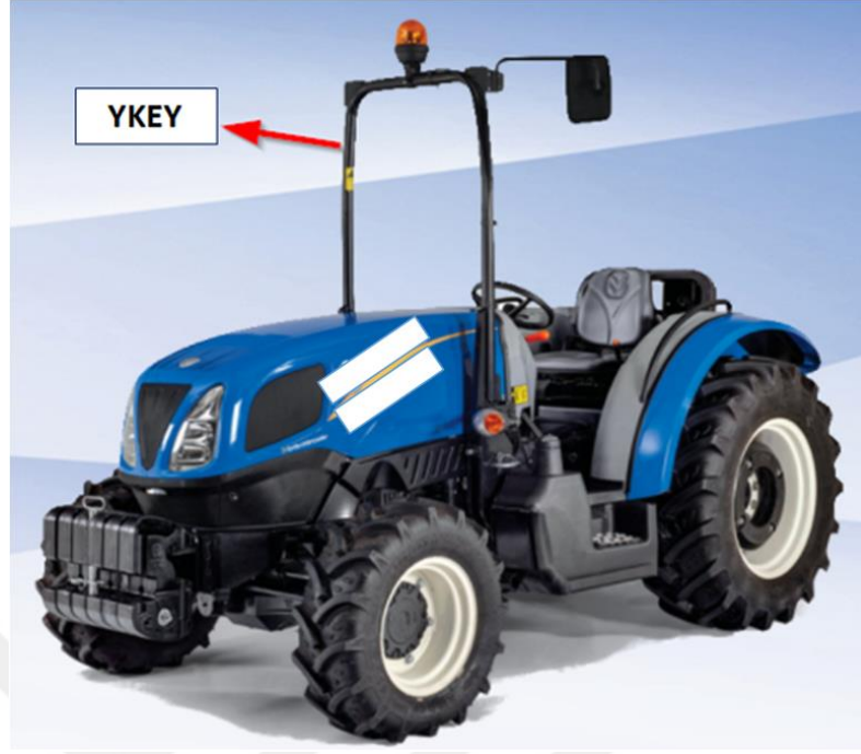
Şekil 1.1 Bir bahçe traktöründe kullanılan örnek bir YKEY tasarımı
