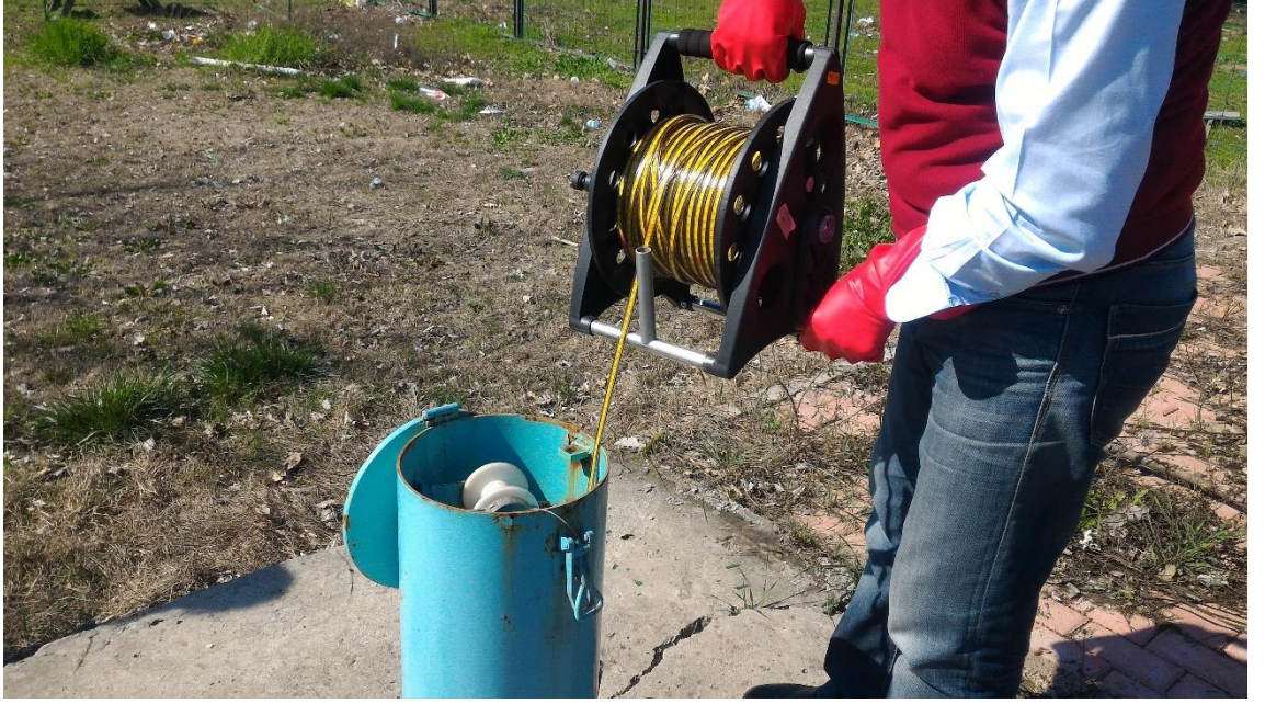
Şekil 3.5. Seviyemetre cihazı ile yapılan manuel ölçümler
