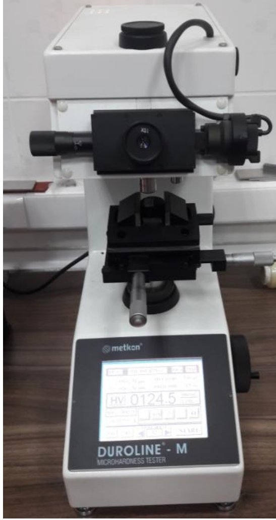
Şekil 3.5. Metkon marka Vickers mikro sertlik test cihazı
