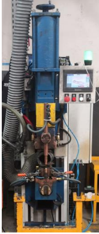
Şekil 3.1. Coşkunöz marka nokta direnç kaynak makinesi
