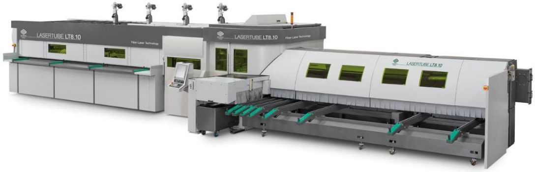
Şekil 3.5. Adige- BLM Firmasına Ait Boru-Profil Lazer Makinesi (Anonim 2016)
