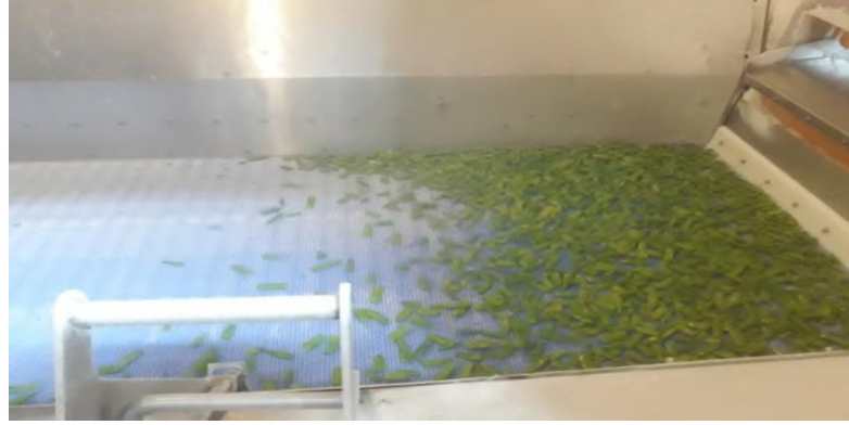
Şekil 3.3. Üretimde kullanılan IQF (Bireysel hızlı dondurma)
