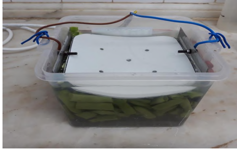
Şekil 3.2. Üretimde kullanılan ohmik ısıtma sistemi
