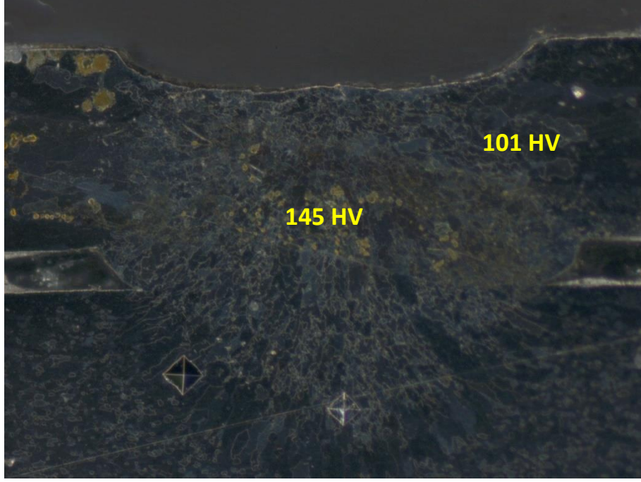
Şekil 4.29. 4 nolu numuneden sertlik ölçümü alınan noktalar
