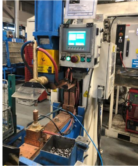
Şekil 3.6. Çalışmada kullanılan direnç nokta kaynağı donanımı
