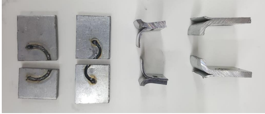
Şekil 4.21. Farklı geometrilerde laser kaynağı denemeleri
