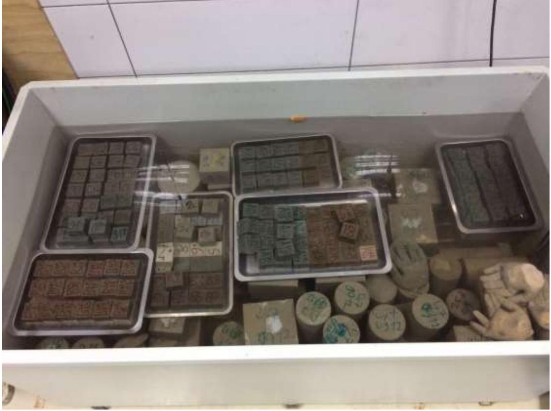
Şekil 3.2. Numunelerin kür havuzundaki görüntüleri
