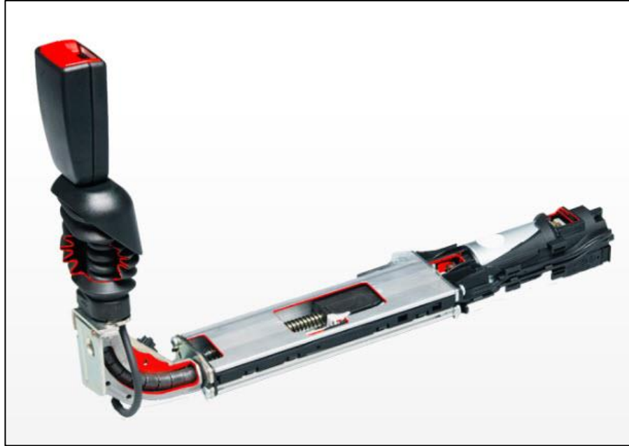
Şekil 2.15. Emniyet kemeri tokasıyla akuple çalışan ön gergi mekanizması (Anonim 2019i)
