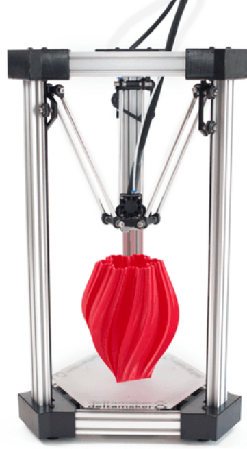
Şekil 2.6. Delta yazıcı ( http://hitit3d.blogspot.com/2016/12/uc-boyutlu-yazici-tipleri.html )
