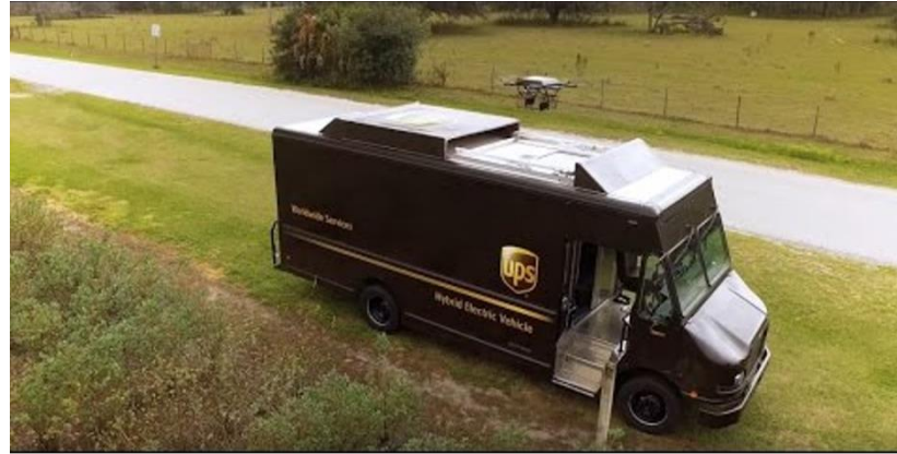
Şekil 1.2. UPS'in İHA ile entegre modifiye dağıtım aracı ( https://www.youtube.com/watch?v=xx9_6OyjJrQ , 2017)
