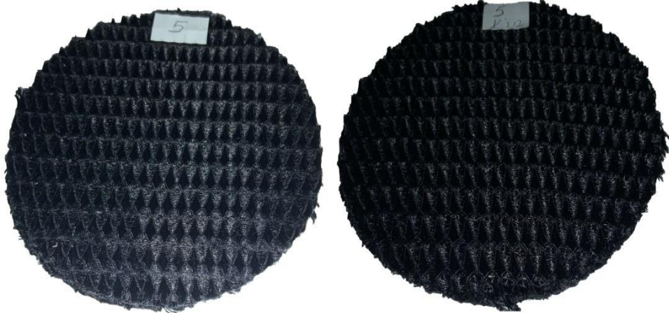
Şekil 3.29. 5 numaralı numuneden bir yüzü kaplamalı diğer yüzü kaplamasız ters kumaş Yarı çekimli iplik olan, kıvrımsız ve bükümsüz bir yapıdaki filament ipliğin (POY) tekstüre işlemi ile tam çekimli ve kıvrımlı bir hale getirilmesi şeklinde oluşturmuş güç tutuşma özelliğine sahip iplikler 450 denye 28 sıklık atkı ve 300 denye 30 sıklık değeri ile çözgü yönünde dokunarak viyol yapıda üretilen 6 numaralı kumaş numunesi geometrik olarak birbirine düz olacak şekilde lamine edilmiştir (Şekil 3.30).
