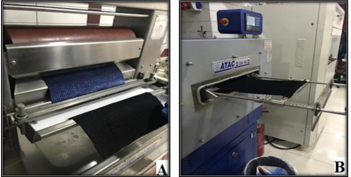
Şekil 3.5. Viyol kumaşa uygulanan sert reçine işlemi
