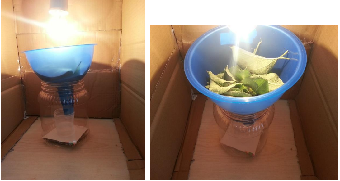
Şekil 3.2. Bitki ekstraksiyonları için kullanılan ev yapımı Berlese Hunisi'nden bir görüntü
