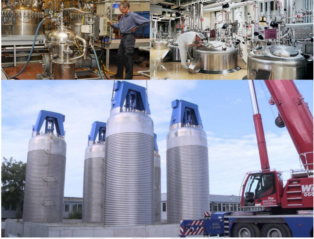
Şekil 1.8. Üretim yapılan farklı boyutlardaki biyoreaktörler
