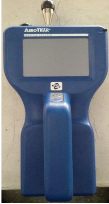
Şekil 3.13. Partikül sayım cihazı
